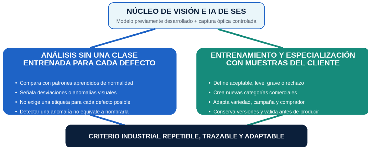
Figura 2. El núcleo de IA combina reconocimiento abierto de desviaciones con especialización controlada por el cliente.
