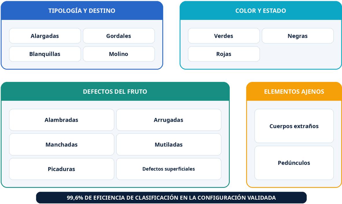
Figura 3. Taxonomía configurada en la plataforma SES para clasificación de aceituna.
